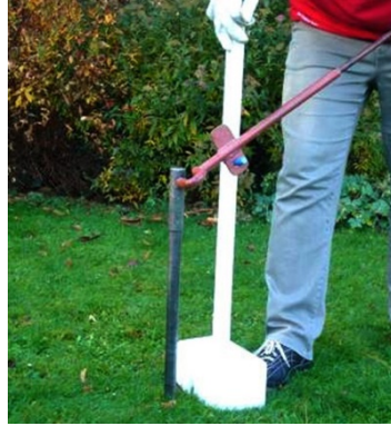
Ziehvorgang des Bohrstocke
